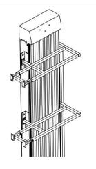
FIG 5.18 144" w/SIDE BRACE (ISOMETRIC BACK)
