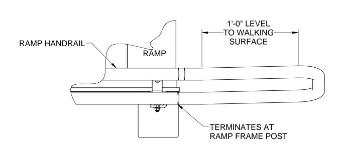
UPPER/LOWER HANDRAIL LOOP DETAIL SCALE 1:3
